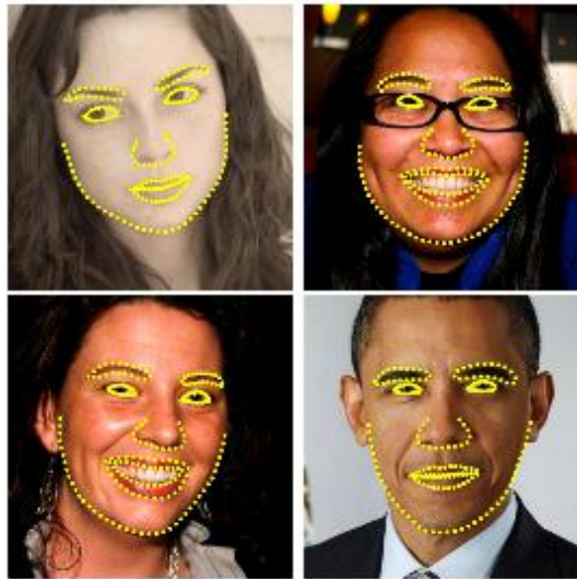
Gambar 2. 2 Hasil yang dipilih pada dataset HELEN. Ensemble Regression Trees digunakan untuk mendeteksi 194 landmark di wajah dari satu gambar (Kazemi & Sullivan, 2014)
